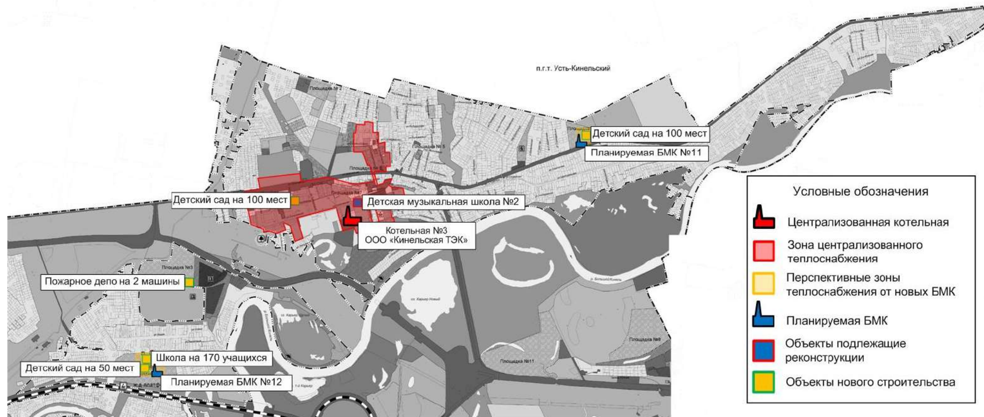
Рисунок 2.4.3 – Перспективные зоны теплоснабжения существующей централизованной котельной, а также блочно-модульных источников тепловой энергии, планируемых к размещению на территории п.г.т. Усть-Кинельский
